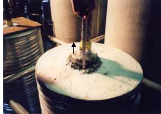
写真 - 7 くさび型アンカー引抜け状況
