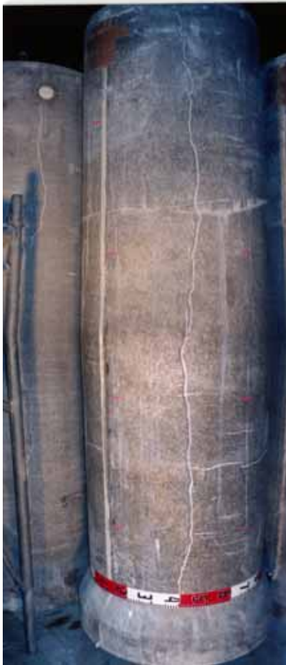
供試体内部状況(ヒューム管直径75cm、高さ245cm、管幹5cm)
