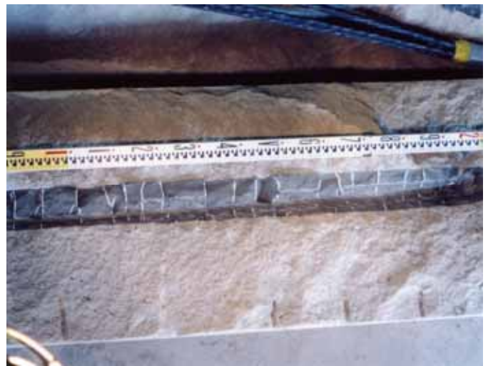
参考:まさつ型アンカー体のクラック状況(引張りキレット間隔6.5cm、テンドンの擦痕跡あり)
