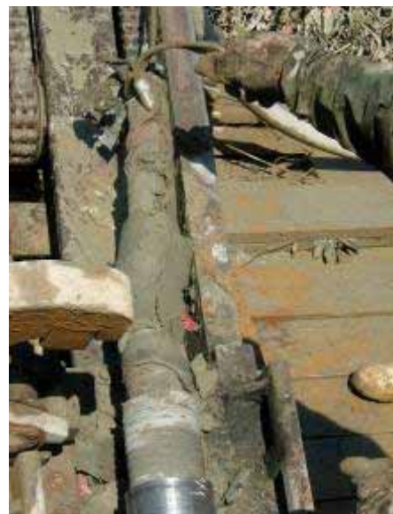
写真 5.2 パッカー位置でケーシング内のセメントミルクが脱水，固化した状況
