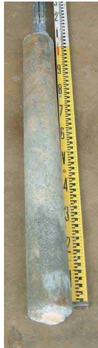
写真 3.12 アンカー体の取り出し
