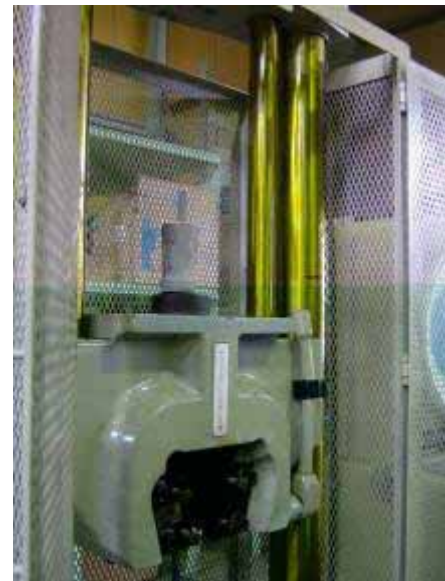
写真 7.2 アムスラー万能試験機による引張り試験
