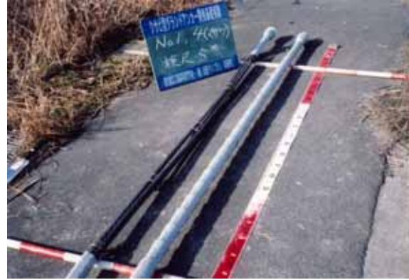
写真 2.16 アンカー一体拘束具(No.1) (非拘束具タイプ No.2 との比較試験)
