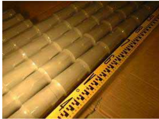
写真 2.8 熱収縮チューブ加工
