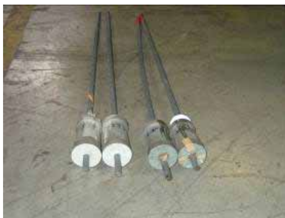
写真 4.3 試験体（拘束具とテンダンを固定した状況） （左 2 体が高強度セメント，右 2 体がエポキシ樹脂仕様）
