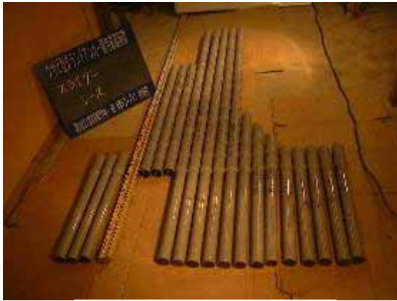
写真 2.7 熱収縮チューブ被覆
