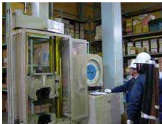
写真 4.5 引張り試験状況 （アムスラー型万能試験機）
