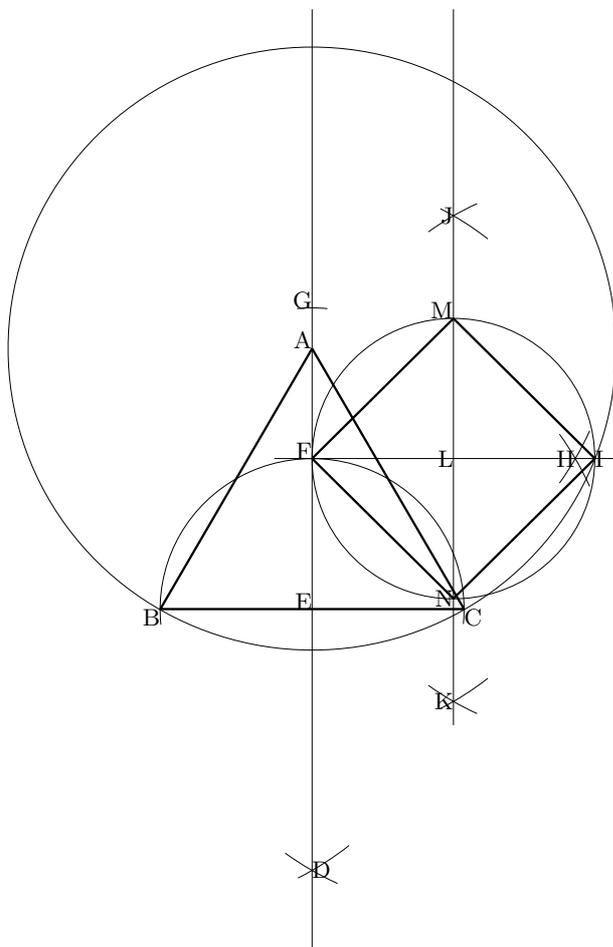
$\triangle ABC$  から始めて、点を順に D, E, F, ..., N まで作図すれば、正方形 FMIN が求める等積正方形である。
