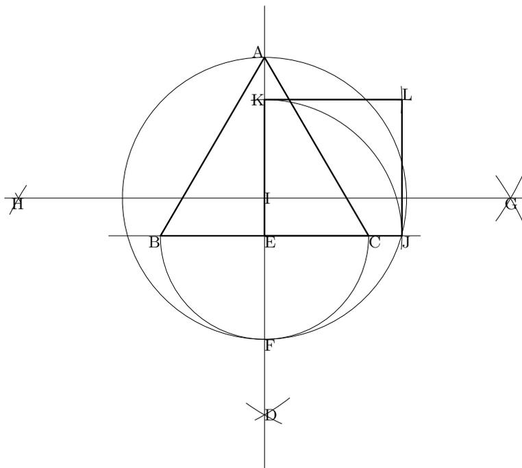
$\triangle ABC$  から始めて, 点を順に D, E, F, ..., L まで作図すれば, 正方形 EKLJ が求める等積正方形である。
