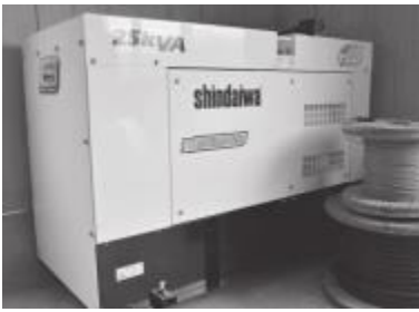
環境対応型マルチ発電機 連続運転：50%負荷時 21.7h
